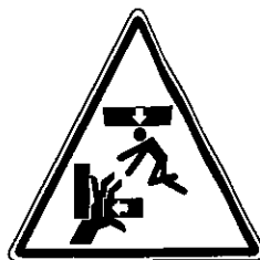
Säkra rörliga delar mekaniskt
