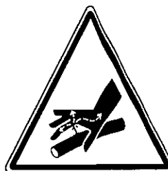
Avlasta hydraulsystemet så att det är trycklöst
